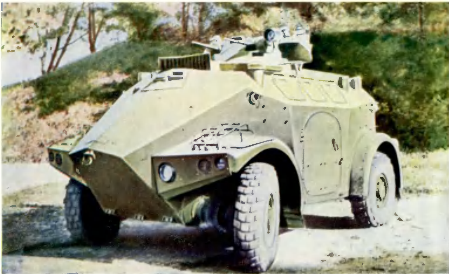
ФРАНЦУЗСКИЙ ПЛАВАЮЩИЙ КОЛЕСНЫЙ БРОНЕТРАНСПОРТЕР «ПАНАР» VAB M3 (4x4). Боевой вес 5,8 т, экипаж два человека, перевозимый десант десять человек. В башне TL-21 смонтированы два 7,62-мм пулемета. Для ведения стрельбы на каждом борту имеется три амбразуры. Для входа и спешивания используются две бортовые и две кормовые двери. Четырехцилиндровый двигатель воздушного охлаждения мощностью 90 л. с. обеспечивает движение с максимальной скоростью до 100 км/ч. Скорость движения на плаву 4 км/ч. Запас хода 600 км
