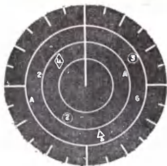
Рис. 5. Внешний вид экрана индикатора пеленга станций радиотехнической разведки AN/ALR-45 и AN/ALR-46
